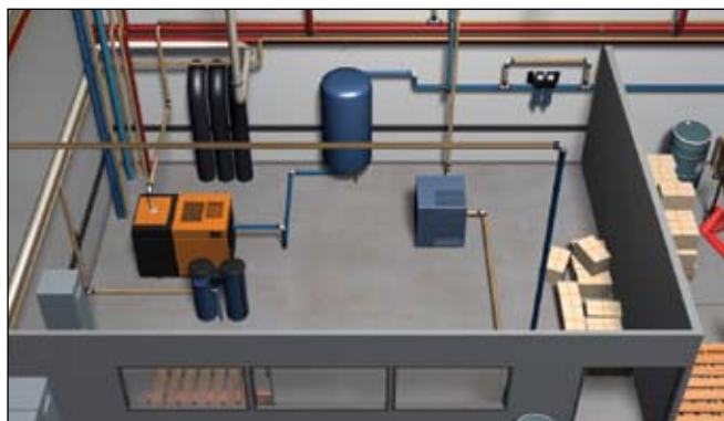
Un compressore convenzionale, con attrezzature esterne di filtraggio e dal funzionamento rumoroso, deve essere posizionato lontano dall'area di produzione. La mancata integrazione può incrementare i costi di installazione.
